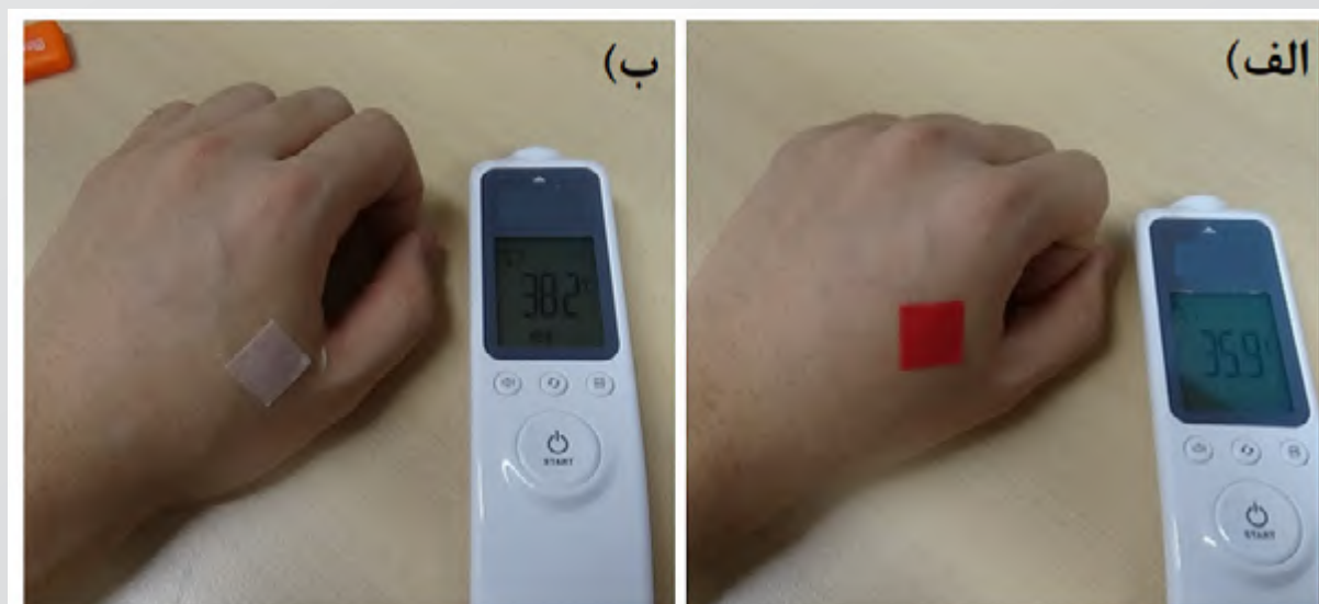
شکل ۱- پارچه ترموکرومیک چسبیده به پوست دست با دماهای مختلف: (الف) دما در شرایط نرمال و (ب) دما در شرایط تب.
