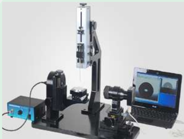
شکل ۲- نمونه‌ای از یک دستگاه زاویه‌سنج ترشوندگی به روش قطره‌ی ساکن.
